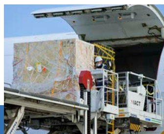
搭降載 到着手荷物・貨物の取り卸しを行い、航空機の出発に向けて、出発手荷物・貨物の搭載を行います。
