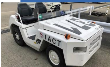
トローイングトラクター55台 ドーリーを牽引する車両
