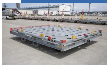
ドーリー575台 ULD（Unit Load Device）を 搬送する台車
