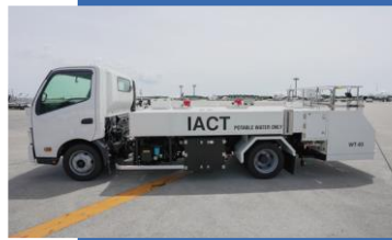
ウォーターサービスカー2台 航空機へ飲料用の水を供給する 車両
