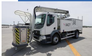
ディアイシングカー4台 航空機に付着した雪や氷を取り 除く車両
