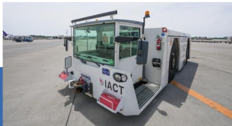
トローイングカー6台 航空機を牽引するための車両
