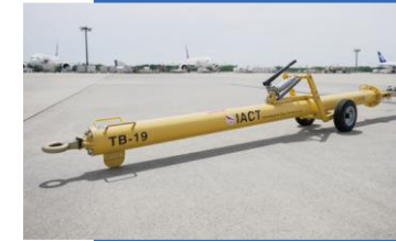
トーパー19台 航空機とトローイングカーを連 結するための棒状の機材
